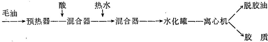
图2 阿伐——拉伐酸脱胶工艺方框图
