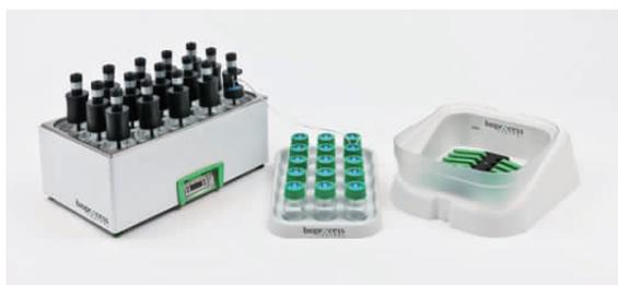
图1 产甲烷潜力自动分析仪
