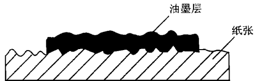
图 2 纸张表面墨层示意图
